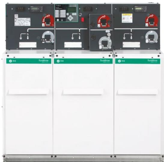
Эксплуатационные характеристики RME соответствует требованиям стандартов МЭК, предъявляемым к герметичным системам под давлением. Корпус RME заполнен элегазом с избыточным давлением 0,23 бар и «запаян» на весь срок службы. Его герметичность тщательно проверяется на заводе-изготовителе, что гарантирует долгий срок службы.
