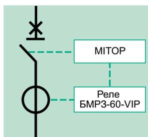
В RME применяются выключатели с номинальным током 200 и 630 А, обеспечивающие защиту трансформаторов и линий. Они оснащаются энергонезависимой релейной защитой (серией БМРЗ-60-VIP или VIP) с автономным питанием от классических трансформаторов тока или датчиков тока.
