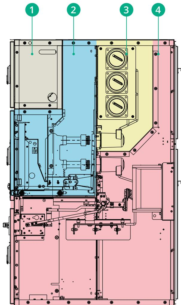
Ячейка в металлическом корпусе состоит из четырех полностью независимых отсеков:
